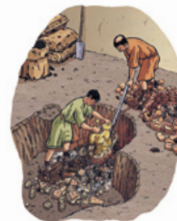
L'atelier de fondeur du Quinconce des Jacobins. À gauche, coulage du bronze dans le moule du torse, à droite, décochage après refroidissement.
