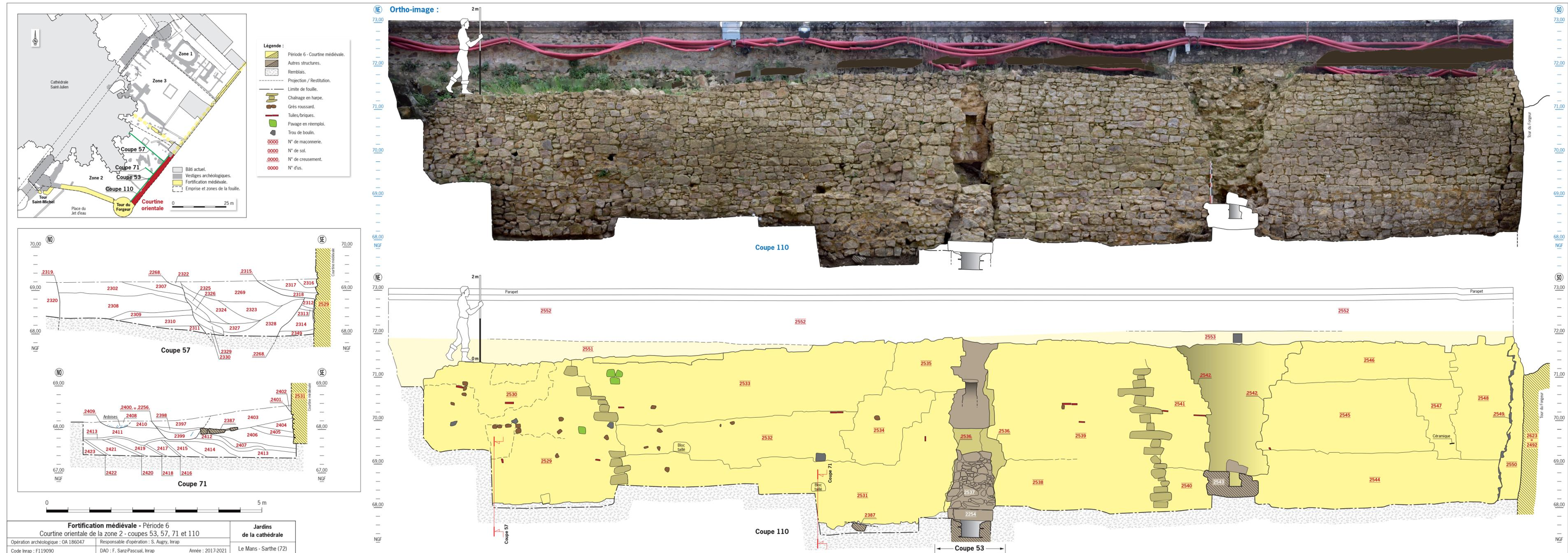
Fig. 348 : Courtine orientale : Ortho-image, relevés architecturaux en élévation et coupes stratigraphiques. DAO : F. Sanz Pascual, Inrap ; Photographie : S. Augry et F. Sanz Pascual, Inrap.
